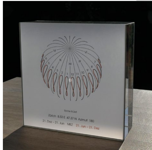
Fig. 6: Prototype du cadran pour Zurich (47,37 N, 8,53 E), avec une exposition sud. La taille de l'appareil est de 15 cm × 15 cm × 6 cm. Le cadran solaire indique à la fois l'heure solaire vraie et l'heure d'Europe centrale (CET). L'heure est lue au centre du point lumineux formé par le passage des rayons du soleil par O . Dans l'exemple, le cadran indique le vrai midi (heure solaire vraie t = 12 heures, angle horaire h = 0 ). Les continents ne sont pas représentés sur ce modèle : la Terre et sa position dans l'espace apparaissent seules au-travers de l'orientation des lignes de l'heure solaire vraie.
