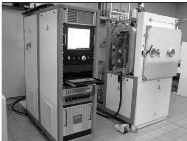
Fig. 1: Photo de l'installation PVD HIPIMS de l'IMA (Institut des Microtechnologies Appliquées):
