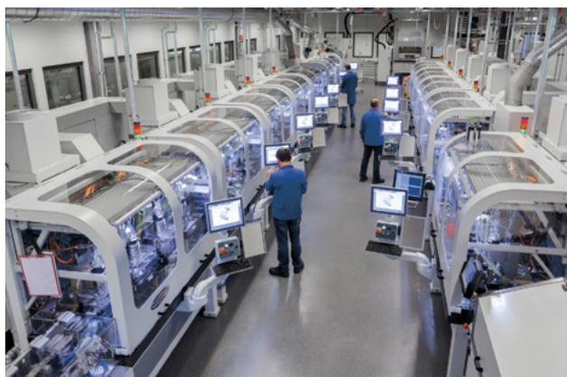
Fig. 3 : Chez ETA, une rationalisation de la production passe par une complexification de la ligne de production plutôt que le produit lui-même. Ici, la ligne d'usinage des ébauches.
