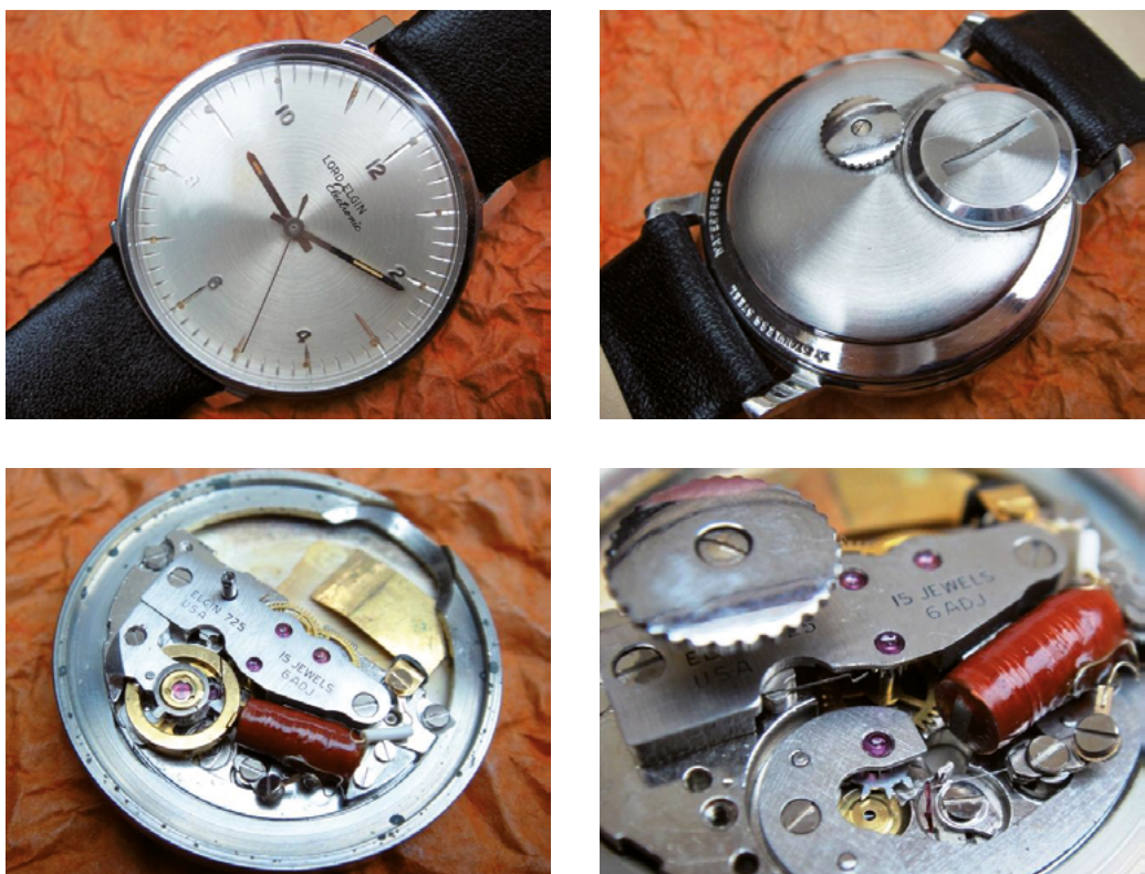
Fig. 3: Calibre électromécanique Elgin 725 datant de 1963. Photos crazywatches.pl.
