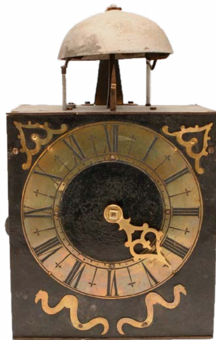
Fig. 1 : Cadran en laiton, affichage une aiguille, indication demie et quarts. Mouvement à échappement à ancre à recul, barillets tambours en bois, pendule en chaîne d'arpenteur avec toupie. Collection ETVJ, photo Espace horloger de la Vallée de Joux.
