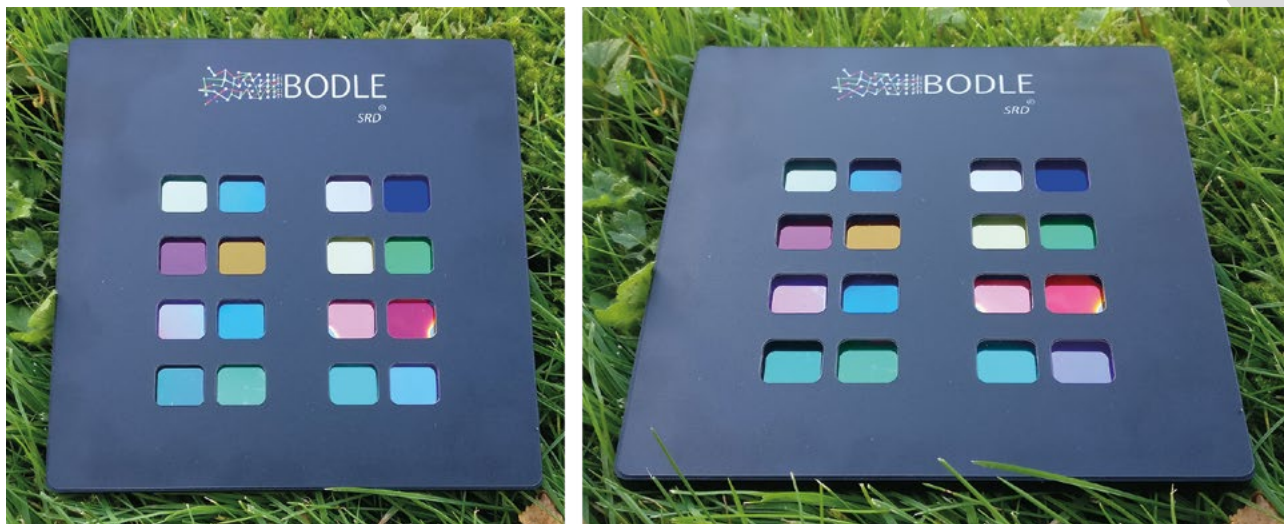
Fig. 3: Plusieurs couleurs obtenues en réglant l'épaisseur de la couche de PCM de l'empilement à couches minces. Chaque empilement est illustré dans les deux états: l'état amorphe et l'état cristallin. Chaque modèle d'empilement est photographié sous deux angles différents pour montrer la faible dépendance angulaire obtenue avec cette technologie.
