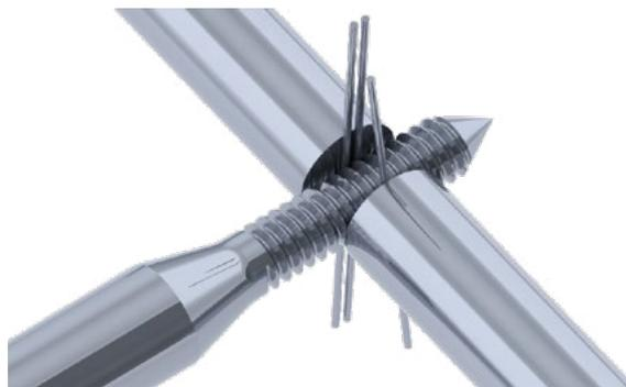
Fig. 13: Tampon fileté mesuré entre piges.
