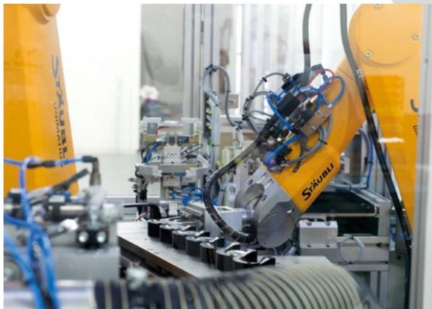
Fig. 11: Ligne de feutrage entièrement automatisée.
