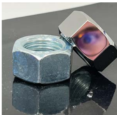
Fig. 3 : exemple d’exercice de lapidage et de polissage sur un écrou industriel.
