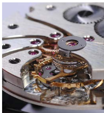
Fig. 1 : Vue de détail de la montre-école avec courbe Breguet et coqueret usiné en interne.
